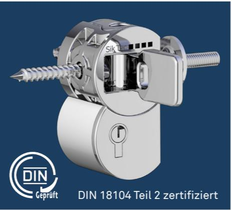
Diese Sik Lock Variante ermöglicht es, über ein Einstellschloss das Öffnen des Verriegelungssystems zu sperren. Zum Einbau werden mit Hilfe einer Schablone zwei 30 Millimeter Topfbohrungen übereinander in den Rahmen eingebracht und Sik Lock SL-2 als eine vormontierte Einheit eingesetzt.
