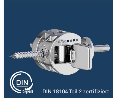
Genial einfache Montage, optisch kaum erkennbar und mit einem hohen Wirkungsgrad der Sicherheit Ihres Fensters, so lässt sich Sik Lock am besten beschreiben. Topfbohrungen von 30 Millimeter Durchmesser im Blendrahmen genügen, um Sik Lock einzubauen. Der Verriegelungsbolzen
