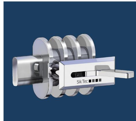
Ein einzelnes Sicherheitsmodul Sik Bolt SB-1 ist ausreichend, um das Getriebe von ein- und zweiflügeligen Fenstern zu fixieren. Zur Montage werden mittels Bohrschablone im Flügel Topfbohrungen eingebracht und das Sik Bolt SB-1 Modul mit Spezialkleber eingeklebt.
