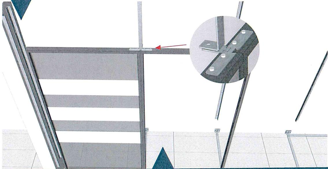
Das erste Wandelement in die Bodennoppen setzen und an der Wandbefestigungsschiene anschrauben. Daneben das Türelement in die Noppen stellen. Mit dem BLE0003 + BLE0006 oben befestigen, die Versteifungslasche festschrauben und die Elemente mit dem Sechskantschlüssel fixieren.
