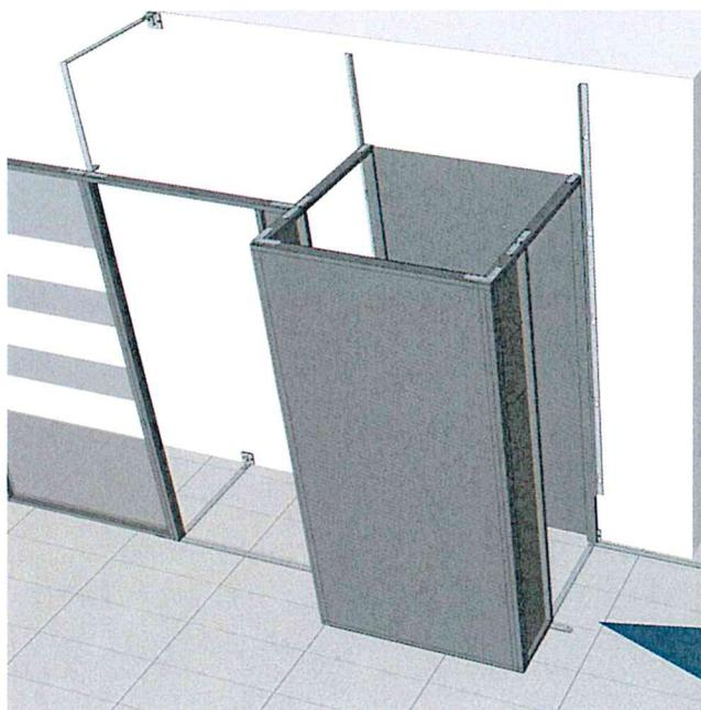
Bei der Personalschleuse auch erst die Elemente in die Noppen stellen, oben fixieren mit den Edelstahlelementen und an der Wandhalterung festschrauben.
